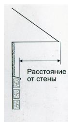
Соедините на земле верхние дуги с верхней частью лестницы. Закрепите их болтами M8x40 и гайками M8. Закрепите подогнанные ножки к лестнице с помощью скоб и шурупов. Удостоверившись, что они находятся на правильном месте, натяните закрепительные винты. Верхние ножки должны находиться между второй и третьей перекладиной. Следующие будут на расстоянии 3 м друг от друга
